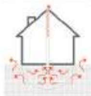
Instalación de un sistema de despresurización del terreno B_3
